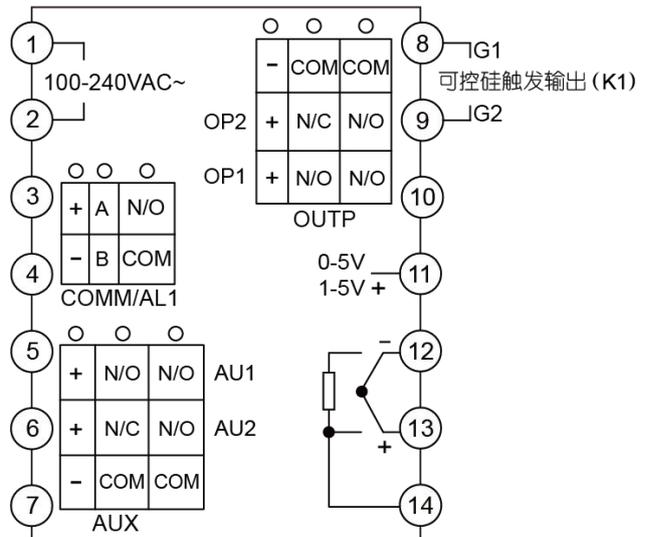
**D61 型面板仪表 (48X48mm) 接线图如下:**
