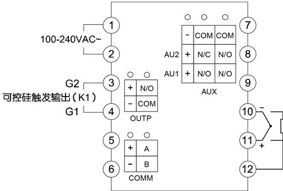
注 1: 4~20mA 线性电流输入用 5 欧高精密电阻变为 20~100mV, 然后从 11、10 端输入。
