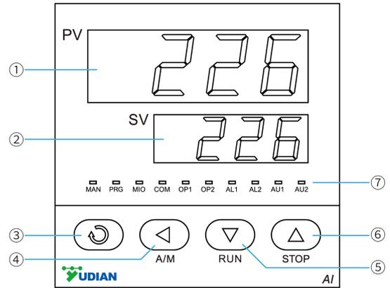
仪表上电后进入基本显示状态，此时仪表上、下显示窗分别显示测量值（PV）和给定值（SV），下显示窗还可交替显示以下字符表示状态：①“orAL”，表示输入的测量信号超出量程；②“HIAL”、“LoAL”、“HdAL”或“LdAL”时，分别表示发生了上限报警、下限报警、偏差上限报警、偏差下限报警；③“StoP”表示处于停止状态。
